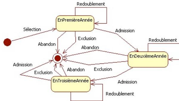
b) Le fait d'utiliser un automate hiérarchique va nous permettre de simplifier l'apparence de notre réponse, en recourant à un état-mémoire H, chargé de conserver le nom de l'état quitté lors de l'arrivée de l'événement *Redoublement* et en utilisant la factorisation de l'événement *Abandon* :
